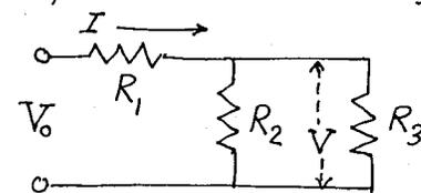
$$V = V_0 - IR_1 = V_0 - \frac{V_0 R_1 (R_2 + R_3)}{R_1 R_2 + R_1 R_3 + R_2 R_3} = V_0 \frac{R_2 R_3}{R_1 R_2 + R_1 R_3 + R_2 R_3}$$
